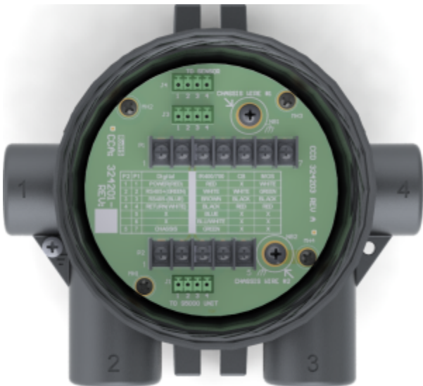
Figure 23 Connexions électriques de la boîte de jonction
